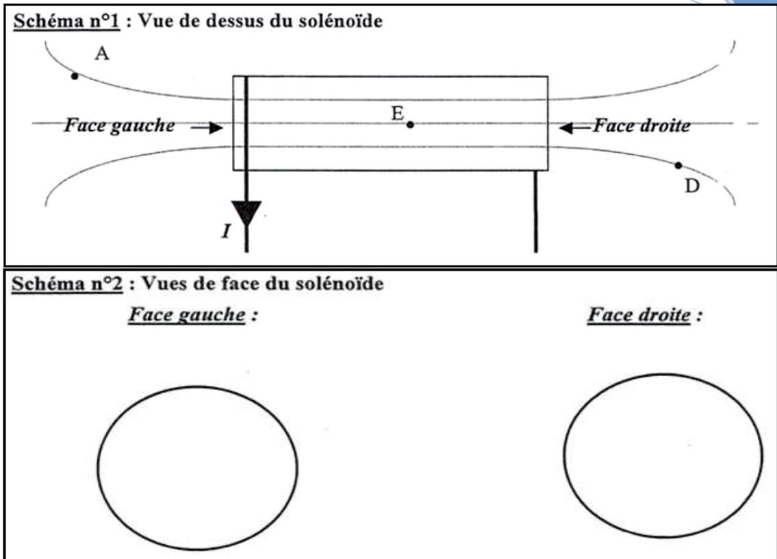
2.1 Le schéma n°1 représente le spectre magnétique du solénoïde lorsqu'il est parcouru par un courant continu  $I$ . Représenter au point E, le vecteur champ magnétique  $\vec{B}$  et dessiner aux points A et D, les orientations prises par de petites aiguilles aimantées disposées en ces points.
