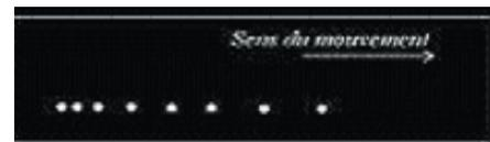
Chronophotographie d'un corps en mouvement rectiligne uniformément accéléré.
