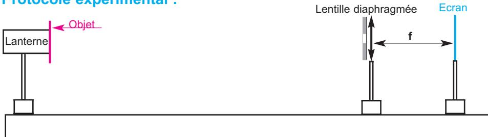
L'objet lumineux (une fente en forme d'une lettre, pratiquée dans un plan opaque et éclairée par une lanterne) est disposée à une distance de l'ordre de **1,5 m à 2 m** de la lentille.
