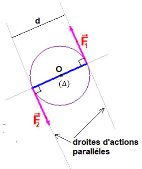
$(\vec{F}_1 ; \vec{F}_2)$  est un couple si  $\begin{cases} \vec{F}_1 + \vec{F}_2 = \vec{0} \\ \vec{F}_1 \text{ et } \vec{F}_2 \text{ ont des droites d'action différentes} \end{cases}$
