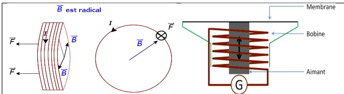
L'énergie électrique est transformée en énergie mécanique puis en énergie sonore.
